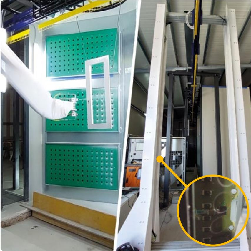
Easy prog PORTAL es un sistema compuesto por un portal equipado con barreras fotoeléctricas y software capaz de generar automáticamente la trayectoria de pintura.
