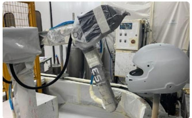
Instalación con Lesta LEBOT WP en un pequeño transportador móvil con panel integrado. El robot está configurado para repetir un movimiento en continuo.
