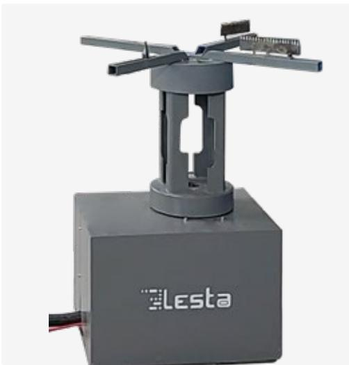
**Lesta ROTATION UNIT RT** es un dispositivo de suelo que permite sujetar y rotar las piezas perpendicularmente al suelo para pintarlas.
