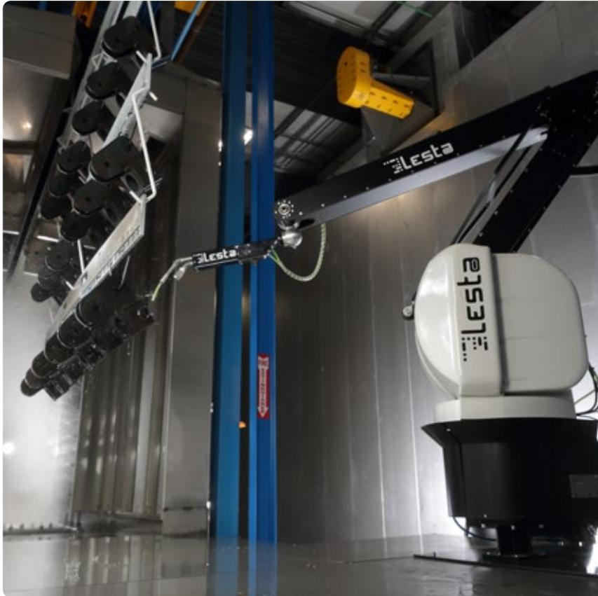
Este accesorio se compone de una pistola especial capaz de soplar aire o aspirar el agua depositada en la superficie de la pieza después del túnel de lavado y secado.
