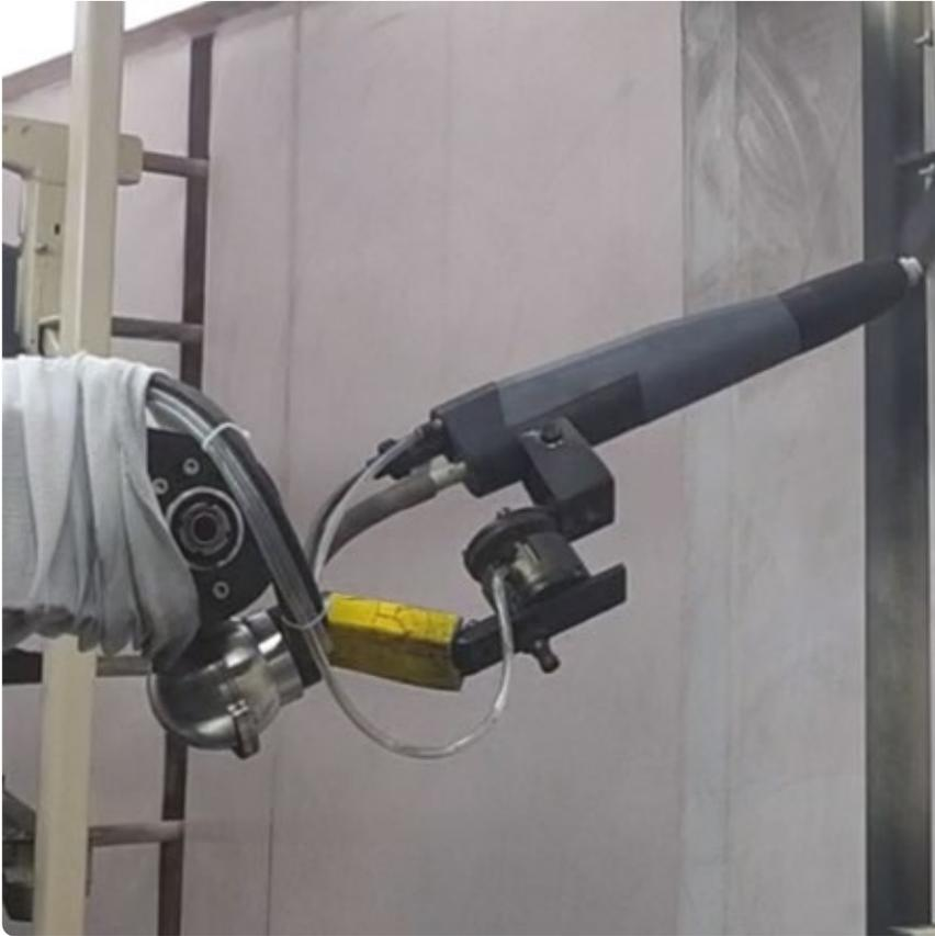
El sistema anticoliión Lesta es un dispositivo neumático especial montado entre el soporte de la pistola y la propia pistola, que protege a ambos de sobrecargas causadas por impactos.
