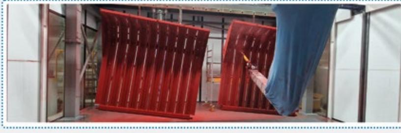
**Image match 3D pro** es un sistema compuesto por software de gestión y uno o más escáneres 3D montados en una línea, capaz de reconocer las dimensiones de objetos tridimensionales y asociarlos con el programa de pintura correspondiente.
