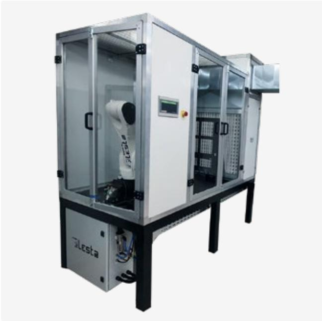
Sistema completo para la pintura con pequeñas cantidades de pintura, ideal para el procesamiento de muestras de pintura y objetos de prueba, o para realizar pruebas con parámetros de pintura específicos. Una vez optimizados, estos parámetros también se pueden aplicar a la producción a gran escala.
