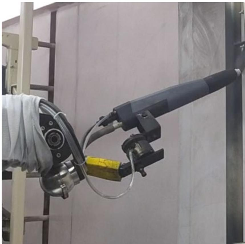
Le système anti-collision Lesta est un dispositif pneumatique spécial monté entre le support de pistolet et le pistolet lui-même, qui protège les deux contre les surcharges causées par des impacts.
