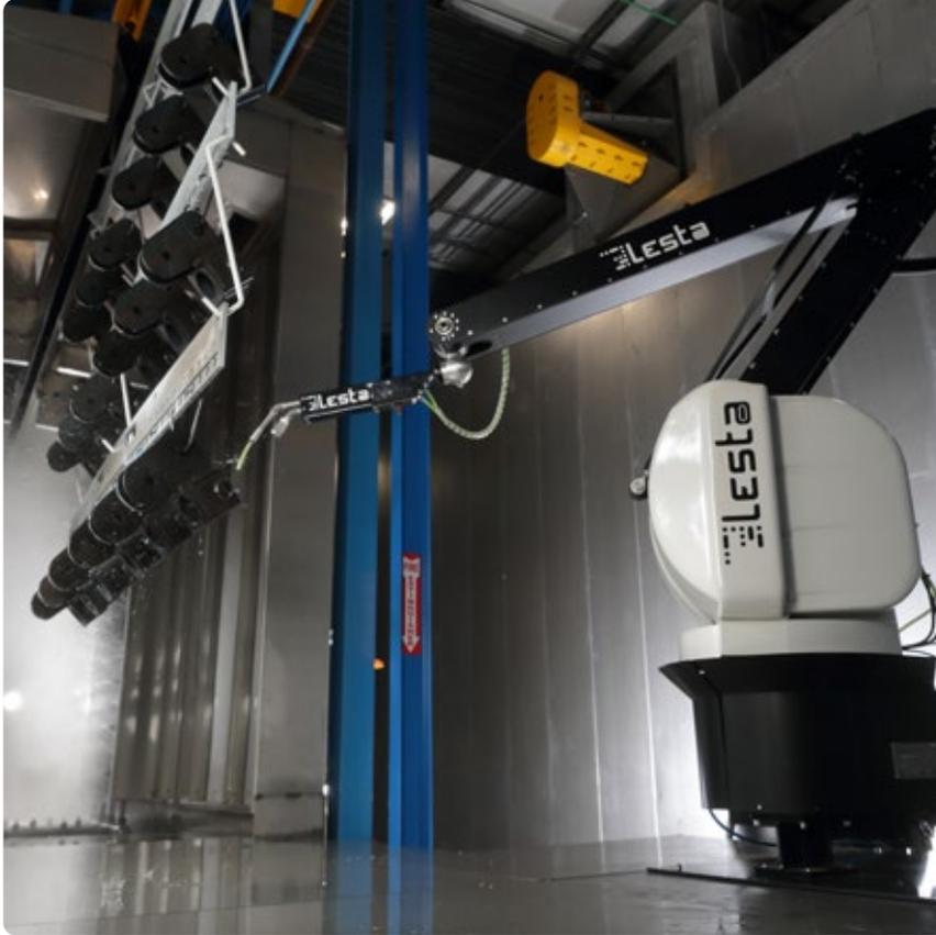
Cet accessoire se compose d'un pistolet spécial capable de souffler de l'air ou d'aspirer l'eau déposée sur la surface de la pièce, après le tunnel de lavage et de séchage.
