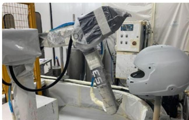
Installation avec **Lesta LEBOT WP** monté sur petit convoyeur mobile avec tableau intégré. Le robot est configuré pour répéter un mouvement continu.
