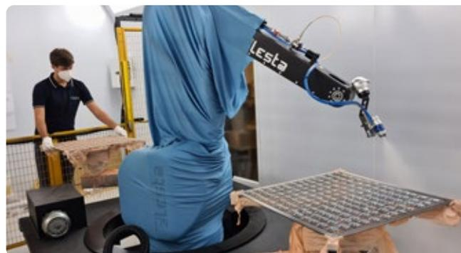
Installation avec **Lesta LEBOT MV A6** sur carrousel avec 2 bras à géométrie variable pour la peinture d'accessoires de mode
