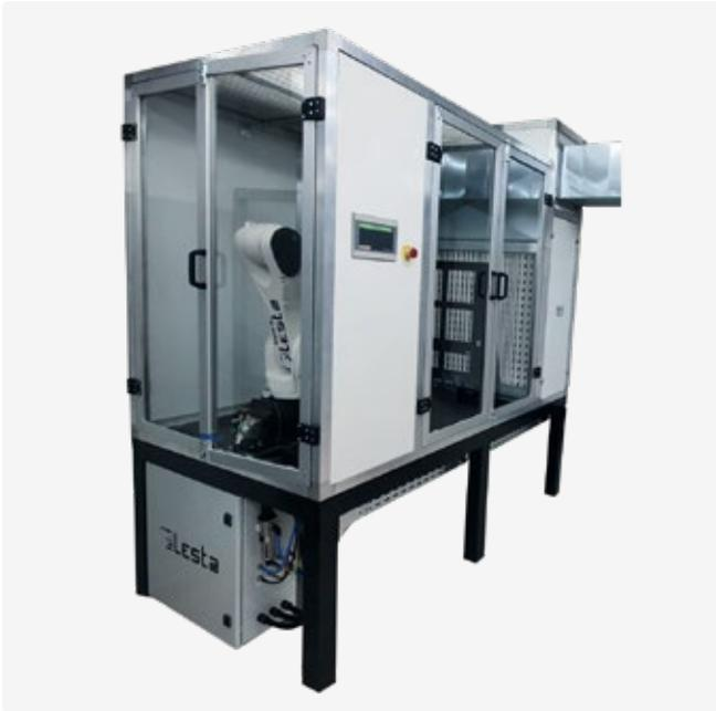
Système complet pour la peinture avec de petites quantités de peinture, idéal pour le traitement des échantillons de peinture et des objets prototypes, ou pour effectuer des tests avec des paramètres de peinture spécifiques. Une fois optimisés, ces paramètres peuvent également être appliqués à la production à grande échelle.
