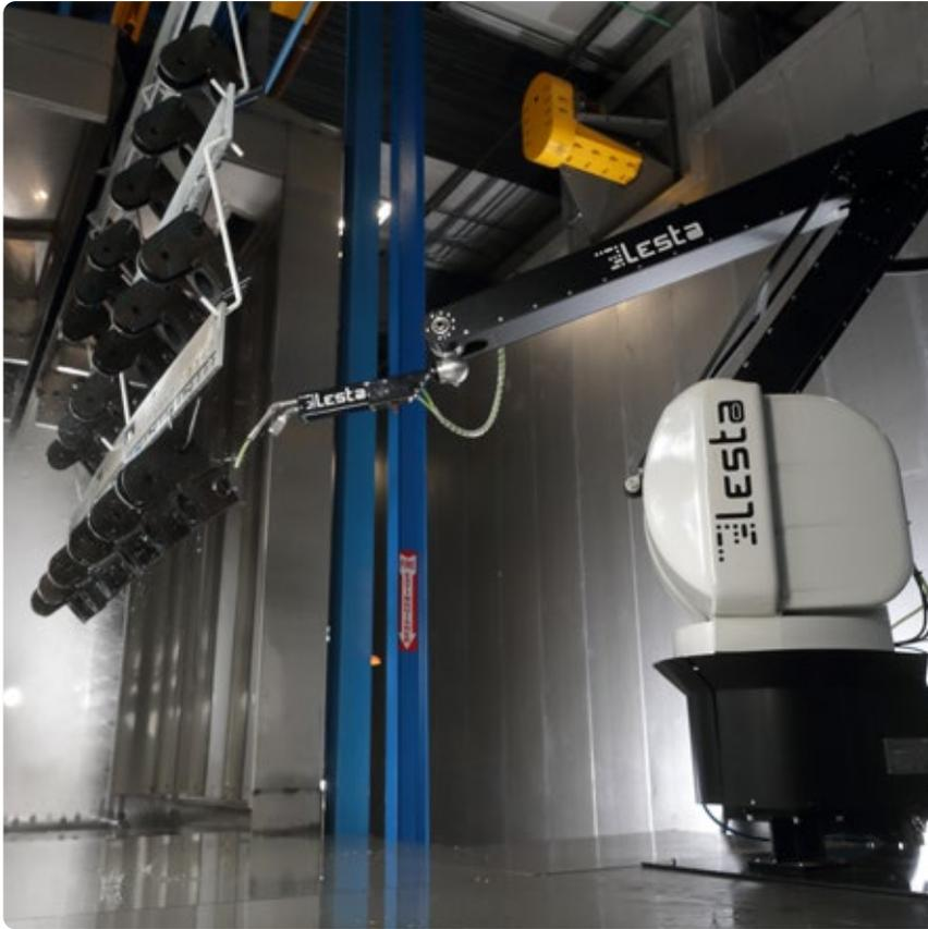
Este acessório é composto por uma pistola especial capaz de soprar ar ou aspirar a água depositada na superfície da peça, após o túnel de lavagem e secagem.
