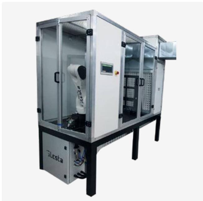
Sistema completo para pintura com pequenas quantidades de tinta, ideal para o processamento de amostras de tinta e objetos de teste, ou para a realização de testes com parâmetros de pintura específicos. Uma vez otimizados, esses parâmetros também podem ser aplicados à produção em larga escala.
