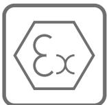
O robot deve ser construído em uma versão à prova de explosão
